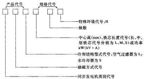
注: 250 kW(kV·A)及以下发电机的规格代号用中心高、铁芯长度和极数表示; 250 kW(kV·A)以上发电机的规格代号可按上述二种表示方法的一种表示,但要在产品技术条件中明确。
